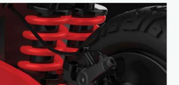
Πίσω διπλή ρυθμιζόμενη ανάρτηση
